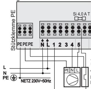
Anschlussleistung max für Pumpe: 200 VA
